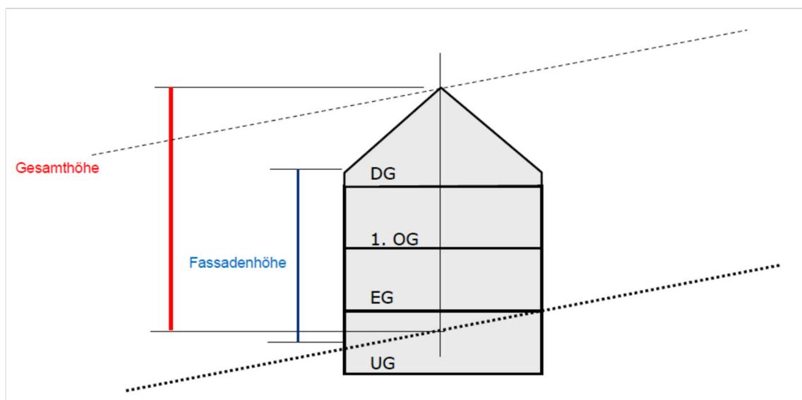
Die Gesamthöhe ist der grösste Höhenunterschied zwischen dem höchsten Punkt der Dachkonstruktion und den Lotrecht liegenden Punkten auf dem massgebenden Terrain.
