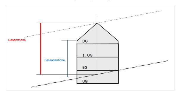
Die Gesamthöhe ist der grösste Höhenunterschied zwischen dem höchsten Punkt der Dachkonstruktion und den Lotrecht liegenden Punkten auf dem massgebenden Terrain. Die Fassadenhöhe ist der grösste Höhenunterschied zwischen der Schnittlinie der Fassadenflucht mit der Oberkante der Dachkonstruktion und der dazugehörenden Fassadenlinie.
